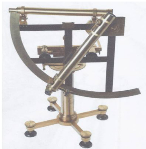
Figura 61 - Quarto de círculo usado no séc. XVIII.
