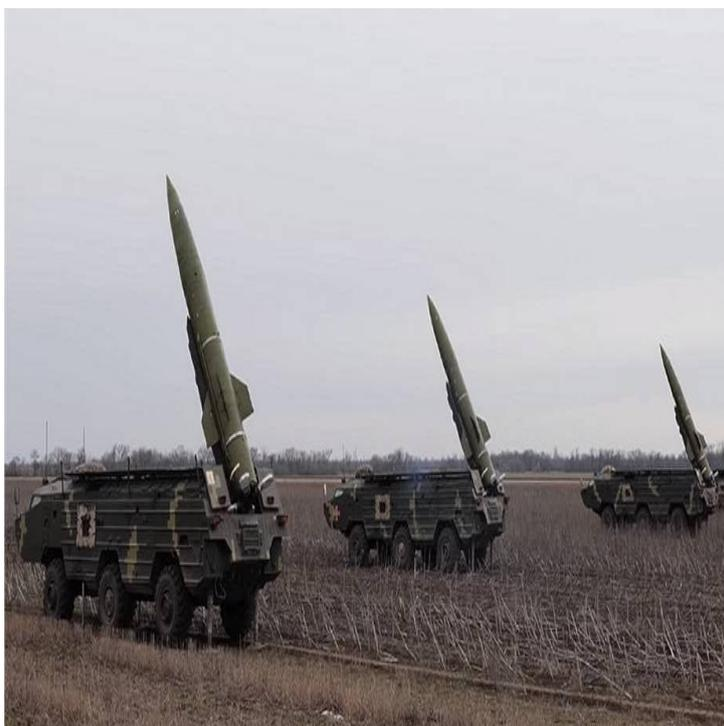
Figura 10 - Lançadores de míssil balístico Tochka-U.
