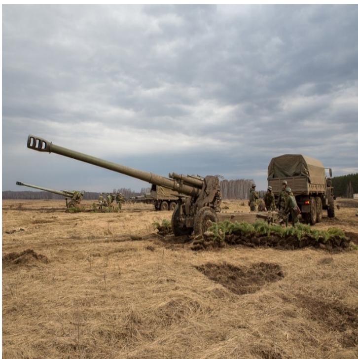
Figura 8 - Peça 2A65 Msta-B calibre 152 mm da Rússia.
