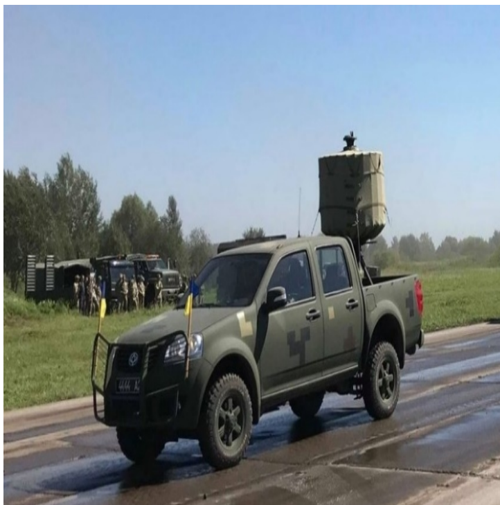
Figura 13 - Radar AN/TPQ-49 dos EUA, na Ucrânia.
