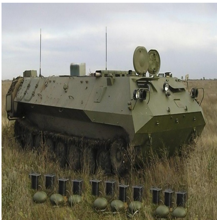
Figura 14 - Sistema Polozhennya-2 com os sensores de som.
