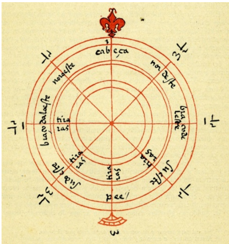
Fig. 6 - Roda da Polar do Livro de Marinharia de João de Lisboa , com as correções constantes a aplicar à altura daquela estrela
