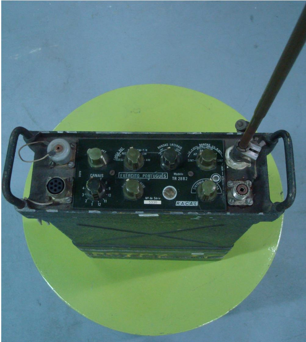
Figura 6 - Emissor-Receptor Racal TR-28.
