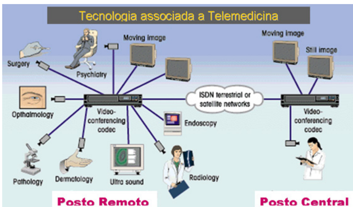
Fig. 8 - Plataforma de TM integrando diversas aplicações
