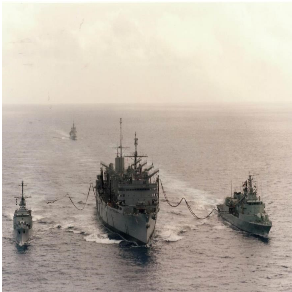
Figura 5 - Fragata Vasco da Gama (à direita) a efetuar reabastecimento no mar, durante a primeira integração de um navio da sua classe na STANAVFORLANT, em 1992.
