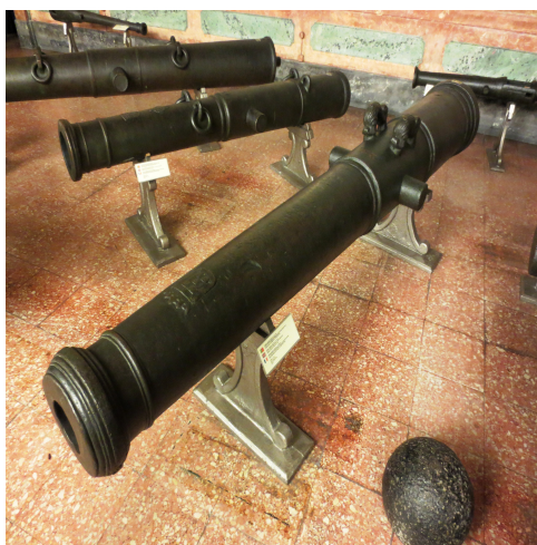
Figura 5 - Em primeiro plano, um Canhão (Espera) em bronze com 12,4 cm (calibre) que disparava balas em ferro de 6 kg. Em segundo plano, um Pedreiro (Camelete) em bronze com 17,3 cm (calibre) que disparava pelouros em pedra de 5,5 kg. (Museu Militar de Lisboa).
