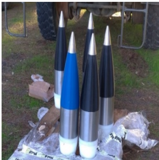
Figura 3 - Lote de granadas inertes PolyShell testado no Regimento de Artilharia N.º 5.
