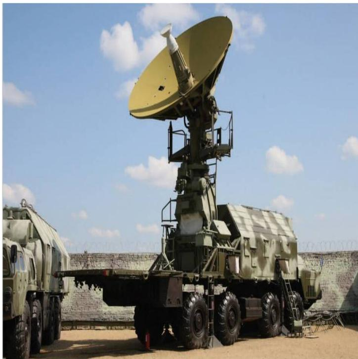
Figura 7 - Estação móvel Tobol em viatura Fazan.
