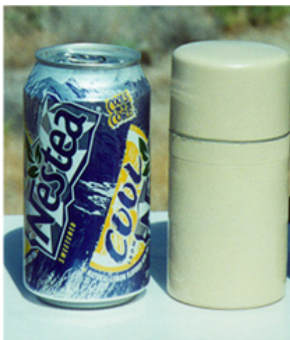
Figura 5 - Imagem de um empastelador de GPS de 1 W (Como comparação, apresenta-se ao lado do empastelador uma lata de Nestea ).
