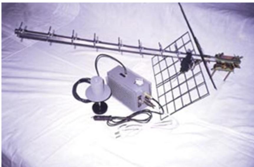
Figura 6 - Empastelador portátil de GPS de fabrico russo.
